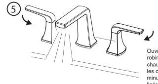
Ouvrir complètement la poignée du robinet; ouvrir les entrées d'eau chaude et d'eau froide, puis rincer les conduits d'eau pendant une minute. Installer de nouveau l'aérateur à la main.
