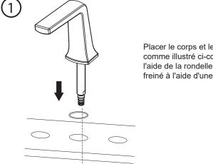
Placer le corps et le joint torique sur la surface, comme illustré ci-contre. Fixer le tout en place à l'aide de la rondelle en métal et serrer l'écrou freiné à l'aide d'une clé pour lavabo.
