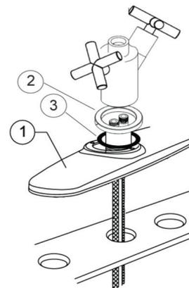
**Étape 1:** Insérez la plaque (1) à trois trous et l'anneau de caoutchouc noir et l'anneau de métal (2 et 3) avant d'insérer le robinet dans l'évier.
