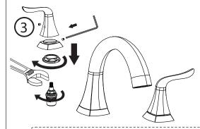
Insérer une nouvelle cartouche dans le logement, visser la base et assembler la poignée à l'aide des vis. Répéter ces étapes pour remplacer l'autre cartouche, s'il y a lieu.
