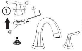
Dévisser la vis ② à l'aide d'une clé hexagonale ③; retirer la poignée ① et la base ④.
