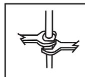
Serrez la connexion avec deux clés anglaises pour empêcher des dommages au corps du tuyau.
