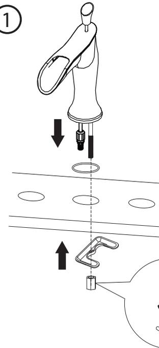
Placer le corps et le joint torique sur la surface, comme illustré ci-contre. Fixer le tout en place à l'aide de la rondelle en métal et serrer l'écrou freiné à l'aide d'une clé pour lavabo.
