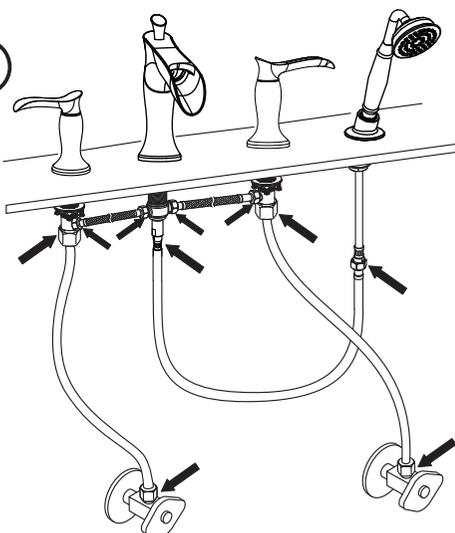
Examiner les raccords aux endroits indiqués par les flèches pour détecter toute fuite et resserrer les raccords, au besoin.
