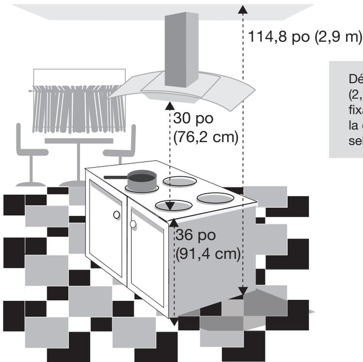
Dégagement maximum du plafond 114,8 po (2,9 m) à 30 po (76,2 cm) de la hauteur de la fixation de la hotte au-dessus du dessus de la cuisinière ou plaque de cuisson (peut varier selon le modèle).
