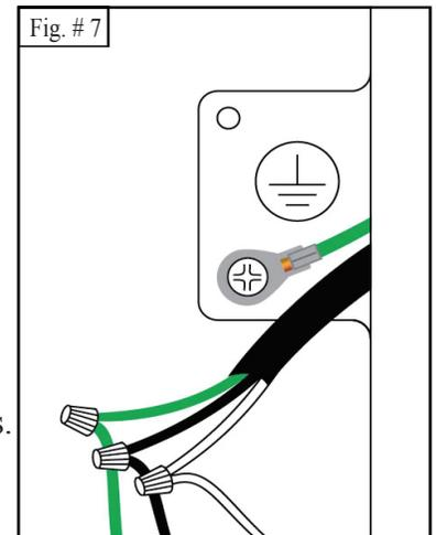
**AVERTISSEMENT DE SÉCURITÉ : Risque de décharge électrique. Cette hotte doit être correctement mise à la terre. Assurez-vous que cela est fait par un électricien qualifié en conformité avec toutes les réglementations nationales et les codes électriques locaux. Avant le branchement, coupez le courant au panneau de service et verrouillez le panneau de service pour éviter sa remise en marche accidentelle.**
