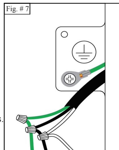
**AVERTISSEMENT DE SÉCURITÉ : Risque de décharge électrique. Cette hotte doit être correctement mise à la terre. Assurez-vous que cela est fait par un électricien qualifié en conformité avec toutes les réglementations nationales et les codes électriques locaux. Avant le branchement, coupez le courant au panneau de service et verrouillez le panneau de service pour éviter sa remise en marche accidentelle.**
