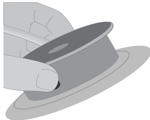
**4** Pour réinstaller une nouvelle rondelle d'éclairage, suivez les instructions **3** en sens inverse.
