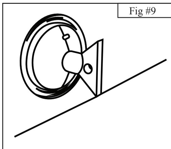
3. Tournez l'ampoule dans le sens antihoraire alors que vous continuez d'appuyer vers l'intérieur. Relâchez votre pression sur l'ampoule lorsqu'il semble qu'elle ne va plus tourner plus loin. Tirez doucement l'ampoule de la douille. Vous pourriez devoir la remuer doucement pour que les « pieds » cylindriques soient correctement alignés avec les plus larges ouvertures dans la douille. (Voir la Figure 8)
