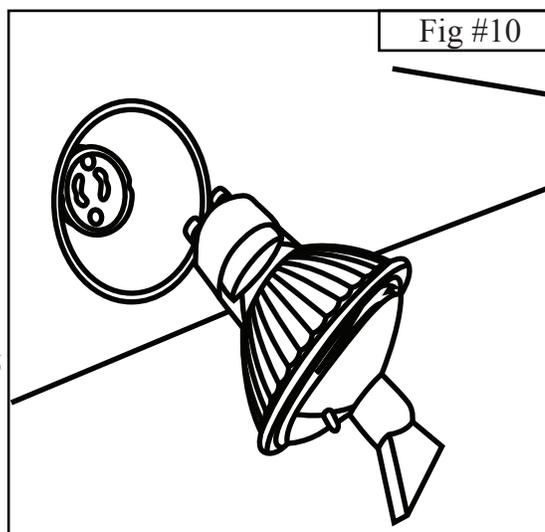
4. Jetez la vieille ampoule. Alignez les dents de la nouvelle ampoule avec les ouvertures larges sur la douille. Appuyez vers l'intérieur des bords de la nouvelle ampoule avec vos pouces et tournez l'ampoule dans le sens horaire aussi loin que possible.
