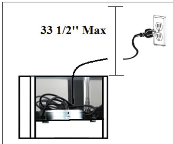
Placer la prise électrique à une distance maximale de 33 1/2 pouces de l'endroit où le cordon sort de la hotte.
